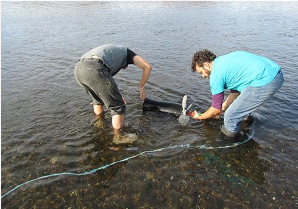
Por su bajo costo, resulta viable la colocación de varias bombas en un mismo curso de agua para ampliar la capacidad de riego y conformar un sistema continuo de provisión hídrica.
