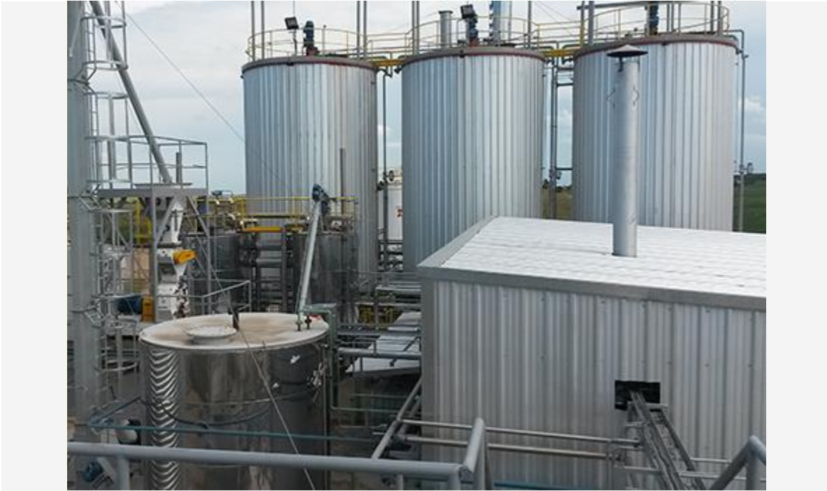
La empresa nacional Porta Hermanos desarrolló un modelo de destilería a pequeña escala totalmente automatizada –denominado “MiniDest”– para producir bioetanol y burlanda a partir de maíz.
